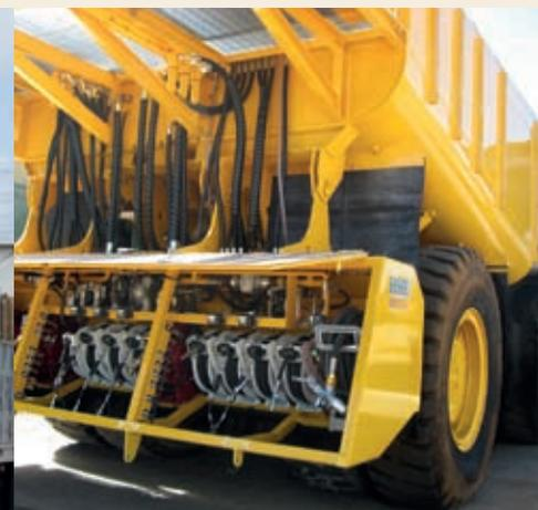
Camión de lubricación equipado con bombas PumpMaster 4 y enrolladores de la serie 504 y 505.
