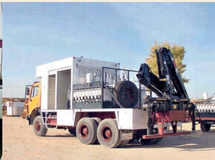
Camión de lubricación, enrolladores de la serie 502, bombas para aceite PM4 y bombas para grasa PM3+3
