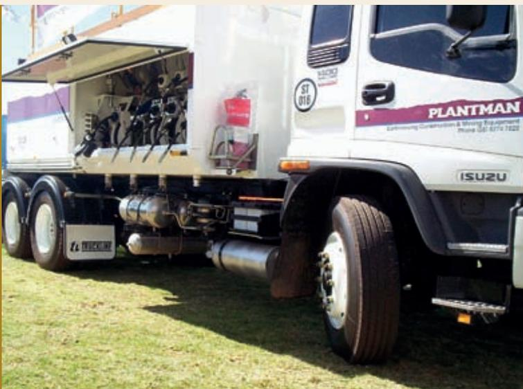
Camión de lubricación, enrolladores de la serie 504 y 505, bombas para aceite PM4 y bombas para grasa PM 3+3
